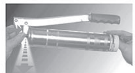
Entlüften durch Drücken des Entlüftungsventils und Nachschieben des Fettfolgedeckels
